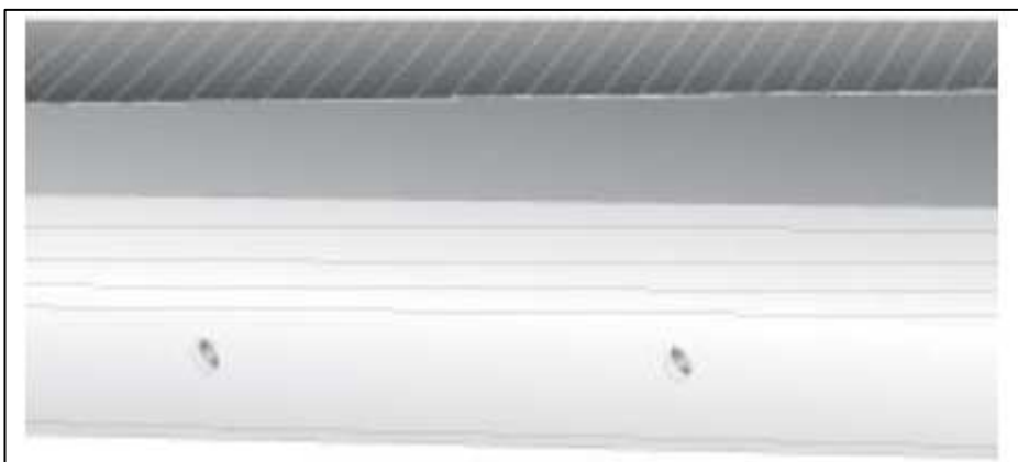
Figura 4-24: fori per connessione al collegamento equipotenziale
